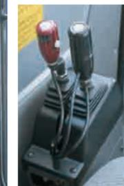
Las palancas de funcionamiento de la grúa se accionan con los dedos y responden de manera segura y continua al operador.
